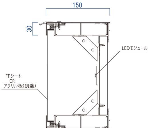
■TS-120 FIX フレーム断面図
